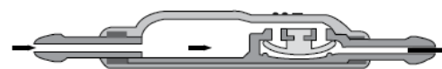
Trayecto de flujo de la válvula de control de flujo de LCR, ultrapequeña
